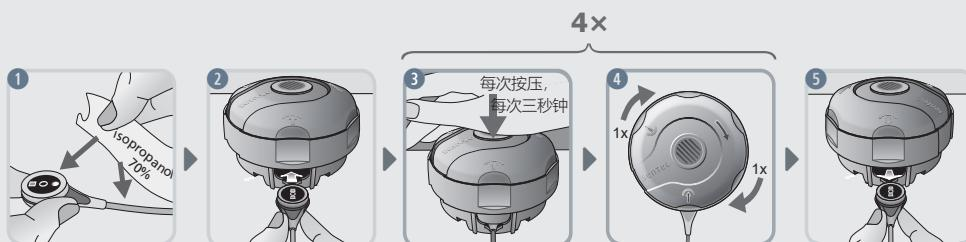
在SDM没有提示更换薄膜但出现下列情况下，也必须另外更换传感器薄膜：如果传感器薄膜损坏或缺失，薄膜出现松动或在膜片下有滞留的空气或膜下电解液已经出现干结。
