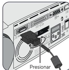
Conecte el cable adaptador para sensor digital al SDM. La conexión está correctamente establecida cuando las dos lengüetas de la clavija encajan con un golpe seco en el puerto de conexión del sensor ⑮.
