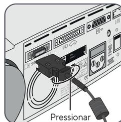
Conecte o Cabo Adaptador do Sensor Digital ao SDM. A conexão é apropriadamente estabelecida quando os 2 grampos do plugue se fixarem na porta de conexão do sensor (15).
