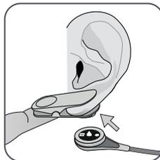
**9.** Puxe o lóbulo da orelha com o Clip de Orelha para uma posição horizontal. Mova o sensor horizontalmente no local com o cabo, preferencialmente, apontando para o topo da cabeça. Insira o sensor no anel retentor do clip pressionando suavemente até que ele encaixe no clip.
