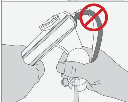
**⚠ VORSICHT:** Vernebler-Kammer nicht biegen, während der Schlauch gehalten wird. Dies kann zu übermäßiger Belastung des roten, konischen Anschlusses führen.
