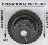
Der Regler **Operational Pressure** steuert den operativen Spitzendruck des gesamten Geräts.
