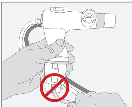
**⚠ VORSICHT:** Sicherstellen, dass der gelbe Verneblerschlauch nicht gebogen ist. Dies kann zu übermäßiger Belastung des Anschlusses führen.
