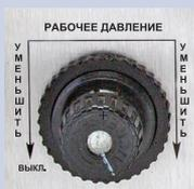
Регулятор **Рабочее давление** контролирует пиковое рабочее давление всего устройства.
