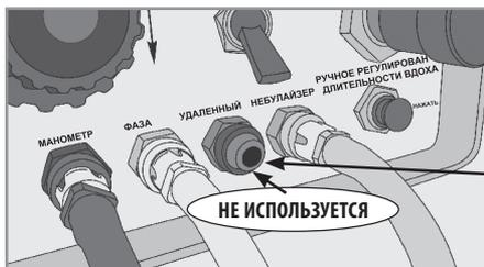
Подключите красную, прозрачную и желтую соединительные трубки к устройству управления IPV®-2С
