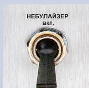
Переключатель включения / выключения **небулайзера** включает и выключает подачу аэрозоля.
