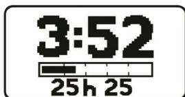
La durata della sessione e la durata di utilizzo complessiva (A) e la pagina delle informazioni di sistema (B) si alternano, rimanendo visualizzate per 2 secondi ciascuna. La visualizzazione alternata delle pagine continua per 5 minuti o fino a quando l'utilizzo riprende e il PDM passa in modalità **Attivo**.
