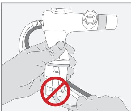
**⚠ 注意：**黄色のネブライザーチューブが折れ曲がっていないことを確認してください。曲がっていると、コネクタに過度のストレスが生じることがあります。
