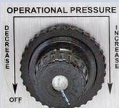
作動圧ノブは、ユニット全体のピーク作動圧を制御します。
