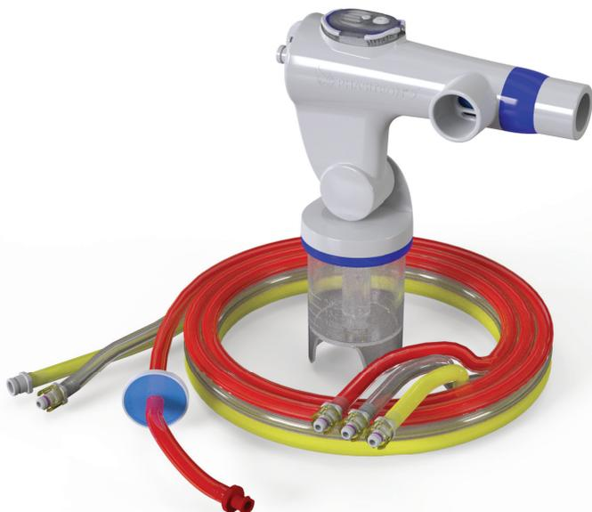
特許取得のPhasitron® 5は、独自のベンチュリを「クラッチ」機構として使用し、過度の圧力から肺を保護します。肺の抵抗を自動的に調節することで、Phasitron® 5は肺胞腔により必要とされる空気最適な量と流れを正確かつ安全に送達します。肺抵抗が低ければ、コンプライアントな肺のように、IPV®-2Cデバイスからパルス化された空気のすべてがベンチュリの開口部に入ります。各エアパルスが追加空気を最高4倍までベンチュリチューブに引き入れます。この低圧混入空気は肺の利用可能空間を自動的に満たします。Phasitron® 5は、易感染性肺であっても、やさしく安全な空気圧を維持するよう継続的かつ瞬時に調節します。
