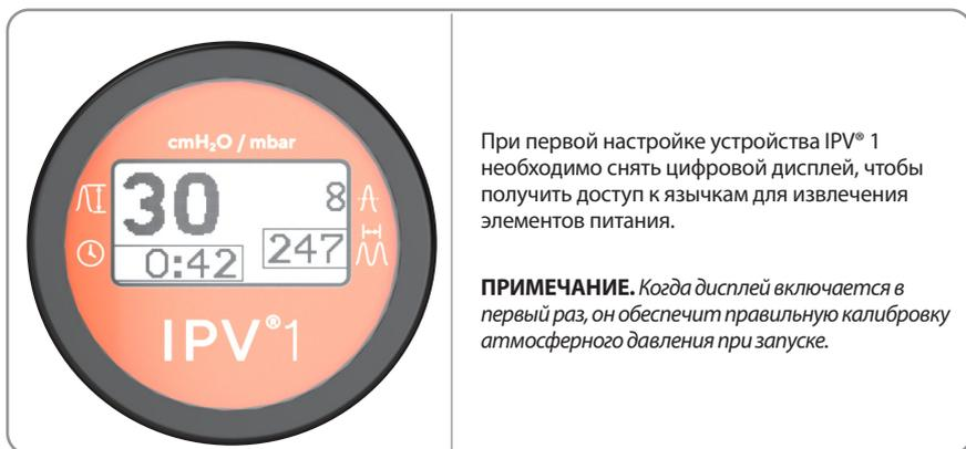
При первой настройке устройства IPV® 1 необходимо снять цифровой дисплей, чтобы получить доступ к язычкам для извлечения элементов питания.
