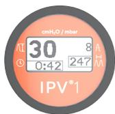
**Цифровой дисплей** считывает и отображает следующие параметры: среднее давление в дыхательных путях (МАР), частота импульсов, время сеанса и амплитуда импульса.
