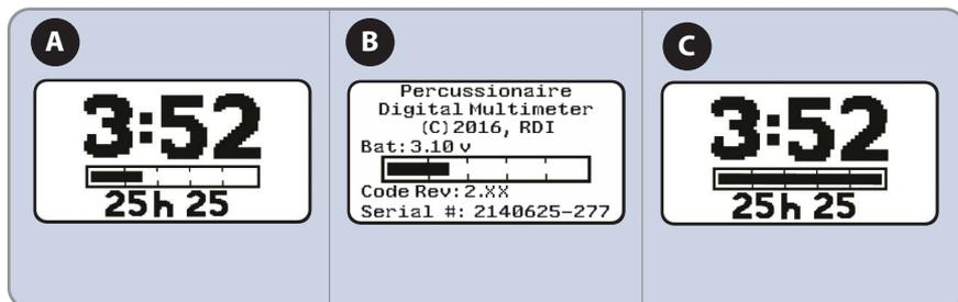
На протяжении этого 5-минутного периода течение времени обозначается заполнением горизонтального столчатого индикатора слева направо с фиксированной скоростью. Если в течение 5 минут эксплуатация не была начата, страница с данными системы перестает отображаться, и дисплей переходит в мигающий режим (2 секунды вкл., 2 секунды выкл.) (C) продолжительностью 25 минут. По истечении 25 минут дисплей переходит в режим Sleep (Сон).
