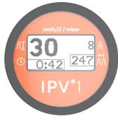
**L'affichage numérique** lit et affiche la Pression moyenne des voies aériennes (P<sub>va</sub>), la fréquence d'impulsion, durée de la session et l'amplitude de l'impulsion.
