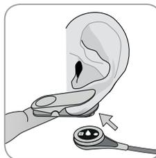
9. Tire del lóbulo de la oreja con el clip de oreja en posición horizontal. Desplace el sensor horizontalmente hacia su lugar con el cable apuntando preferiblemente en dirección craneal e insértelo en el anillo retenedor del clip presionando suavemente hasta que encaje con un golpe seco en el clip. A continuación, ponga la parte posterior del lóbulo de la oreja en posición vertical y, si aún no es el caso, gire el sensor de modo tal que el cable apunte en dirección craneal.
