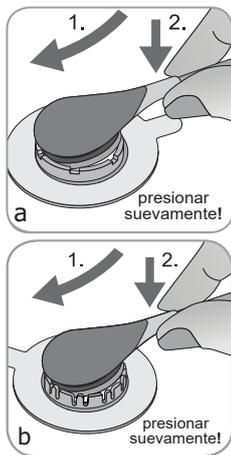
**9.** Sujutando el sensor por el cuello, acerque el MAR desde el lado de la solapa e introduzca primero la nariz del sensor en el anillo retenedor. A continuación, aplique una ligera presión hacia abajo sobre el cuello. La tensión elástica del anillo retenedor colocará el sensor en su lugar con poca o nula presión sobre la piel. Gire el sensor en el anillo y presione el sensor suavemente contra la piel para extender el líquido de contacto.
