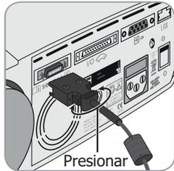
Conecte el Digital Sensor Adapter Cable al SDM. La conexión está correctamente establecida cuando las dos lengüetas de la clavija encajan con un golpe seco en el puerto de conexión del sensor (15).
