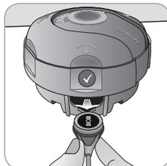
Pressione uma vez mais ou levante o sensor para liberar e remover o sensor do Carregador de Membrana. O símbolo (✓) indica que o carregador de membrana está completo.
