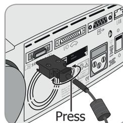
按下黑插头两边的锁松开夹钳，拉出连接线，断开与SDM的连接（见图）。
