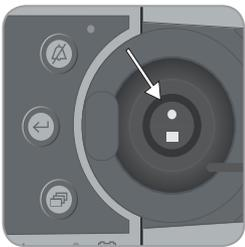
2. 检查校准感应室内的垫圈（剪头指出）。如有必要，用棉签沾70%的异丙醇清洁感应室。
