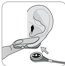
**9.** 向水平方向拉夹了耳夹的耳垂。传感器横向移至到位，传感线最好指向头冠，将传感器轻轻地按到耳夹的卡环中，直到卡入到耳夹中。然后传感线顺着耳垂背面垂直向上一如果不能这样一旋转传感器，使传感线指向头冠。
