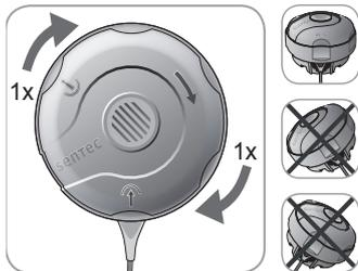
**b.** 顺时针旋转薄膜更换器的顶部到下一个停止点。薄膜更换器保持水平位置！当旋转上半部分时，要固定住更换器的下半部分。
