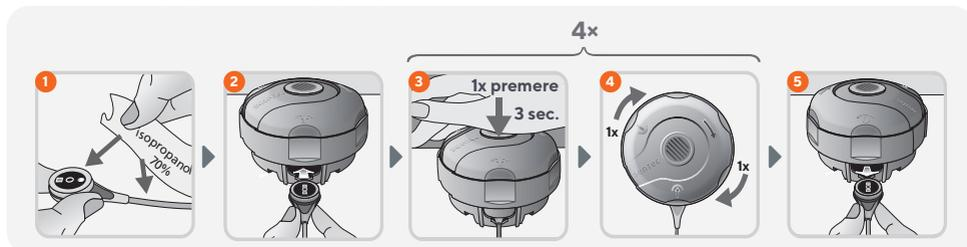
Sebbene il monitor SDM non lo richieda, **anche** la membrana del sensore deve essere sostituita nel caso in cui sia mancante o danneggiata, non garantisca più la tenuta, presenti delle bolle d'aria o delle zone in cui l'elettrolita non è presente.
