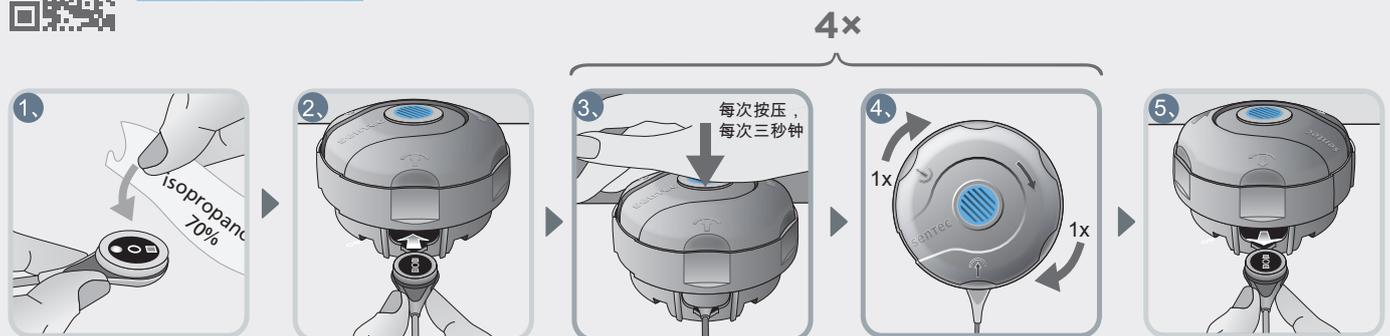
如果SDM没有提示更换传感器膜。当传感器膜损坏或缺失，松动或在膜片下有滞留的空气或干电解质时，则必须更换传感器膜片。
