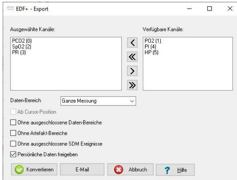
**Kanalauswahl:** Die zu exportierenden Datenspalten können durch Verschieben der entsprechenden Parameterbezeichnungen aus dem Feld „Verfügbare Kanäle“ in das Feld „Ausgewählte Kanäle“ und umgekehrt ausgewählt bzw. aufgehoben werden.
