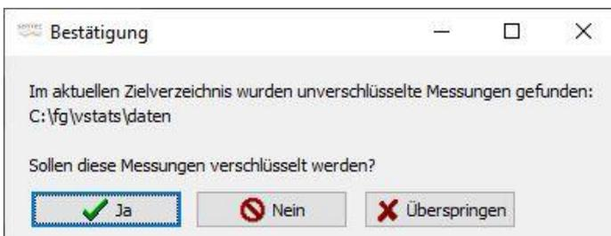
Sie werden gefragt, ob die unverschlüsselten Messungen verschlüsselt werden sollen. Durch Klicken auf „Ja“ wird die Dateiverwaltung mit der unverschlüsselten Messung geöffnet. Durch Klicken auf „Überspringen“ wird das Dialogfeld bei jedem Start von V-STATS erneut angezeigt; beim Klicken auf „Nein“ wird es nie wieder angezeigt (ungeachtet dessen, ob unverschlüsselte Messungen in der Dateiverwaltung vorliegen oder nicht).
