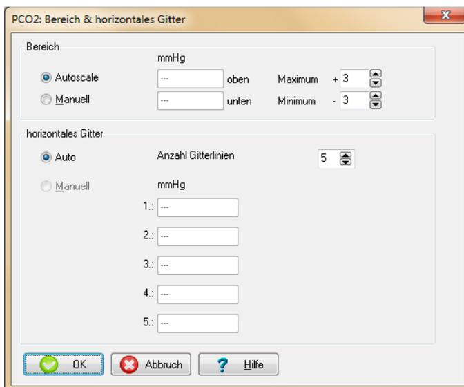
Der Modus für den Anzeigebereich (y-Achse) und das horizontale Gitter für die aktuell geöffnete Messung kann wie folgt eingestellt werden:
