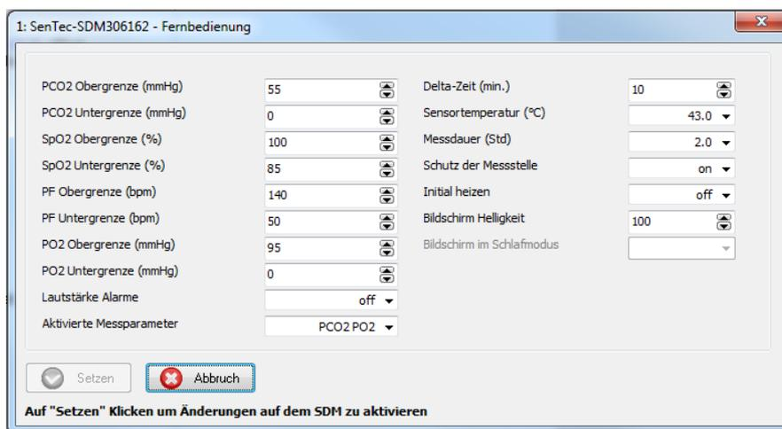
Nach dem Öffnen des Dialogfelds wird die Schaltfläche „Setzen“ abgeblendet dargestellt (funktionslos). Der Parameter, der im Dialogfeld „<X>: <Geräte-/Hostname> - Fernbedienung“ aufgeführt wird, kann entfernt über das entsprechende SDM eingestellt werden. Eine Beschreibung der Informationen zu den verfügbaren Einstellungen finden Sie im technischen Handbuch für den SDM (HB-005752).
