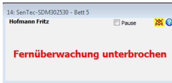
*Hinweis:* Der Alarm „Fernüberwachung unterbrochen“ kann auf einen System- oder Gerätefehler (Netzwerk oder Monitor) hindeuten, der zu einer Unterbrechung der Verbindung zwischen V-CareNeT und dem zugehörigen SDM führt.
