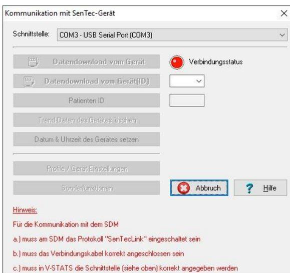
Über die Dropdown-Liste „Schnittstelle:“ oben im Dialogfeld „Kommunikation mit SenTec-Gerät (über serielle Schnittstelle)“ können Sie einen der verfügbaren COM-Anschlüsse des PCs auswählen.
