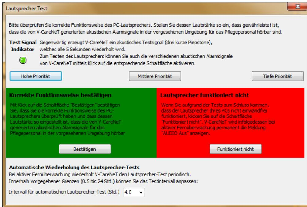
**⚠ ACHTUNG:** Während des Lautsprechertests werden alle Alarmtonsignale von V-CareNeT unterbunden. Stattdessen wird das Lautsprechertest-Testsignal ausgegeben, das alle 5 Sekunden wiederholt wird.
