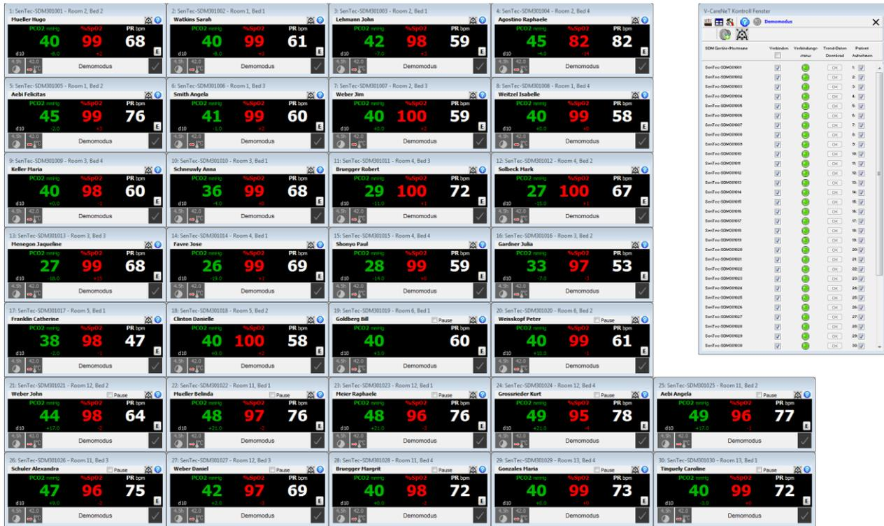
In der Standardkonfiguration des Demomodus enthält das V-CareNeT-Kontrollfenster 40 SDM Geräte-/Hostnamen (SenTec-SDM301001, SenTec-SDM301002,..., SenTec-SDM301040). Eine simulierte Verbindung mit diesen virtuellen SDMs kann über das jeweilige Kontrollkästchen „Verbinden“ hergestellt werden. Zu jeder Station, für die ein Kontrollkästchen „Patient aufnehmen“ verfügbar ist, kann ein Patient aufgenommen werden, sobald die „simulierte“ Verbindung hergestellt wurde (siehe 14.7.1).
