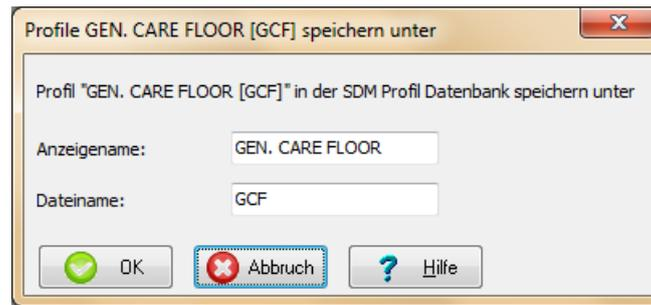
*Hinweis:* Der Titel des Dialogfelds „Profil speichern unter“ enthält auch den Profilnamen (sofern verfügbar), d. h. der verwendete Syntax ist „Profil <Anzeigename> [<Dateiname>] speichern unter“. Eine Beschreibung der Syntax für Profilnamen finden Sie unter 13.2.
