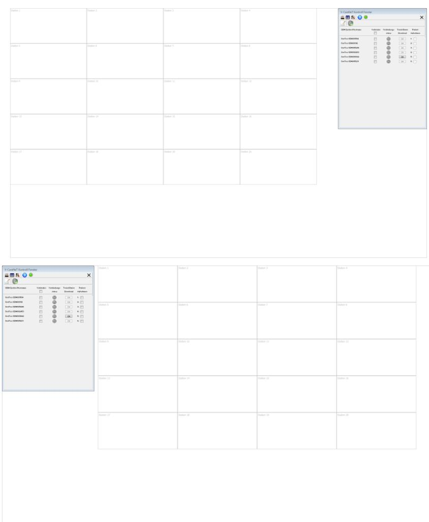
Das V-CareNeT-Hauptfenster zeigt das „V-CareNeT-Kontrollfenster“ (siehe 14.5) optional in der oberen rechten oder oberen linken Ecke (siehe „V-CareNeT Einstellungen“ 12.2). Außerdem enthält es ein Gitter mit nummerierten Zellen, das die Standardpositionen der Fernüberwachungsfenster jeder Station definiert (siehe 14.8.1).
