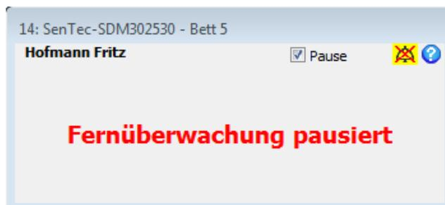
*Hinweis:* Wenn die Verbindung zwischen V-CareNeT und einem SDM unterbrochen wird und das Kontrollkästchen „Pause“ aktiviert ist, wird der Alarm „Fernüberwachung unterbrochen“ nicht ausgegeben. In diesem Fall ist die einzige Anzeige, dass die Verbindung mit dem zugehörigen SDM unterbrochen wurde, der jeweilige Verbindungsstatus-Indikator im V-CareNeT-Kontrollfenster.
