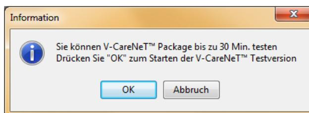
Klicken Sie auf **Abbruch**, um die Aktivierung eines V-CareNeT-Tests abzubrechen. Klicken Sie auf **OK**, um eine V-CareNeT-Test zu aktivieren. Der Test-Zeitraum beträgt 30 Minuten. Die V-CareNeT-Testversion kann beliebig oft reaktiviert werden (nach einem Neustart von V-STATS).
