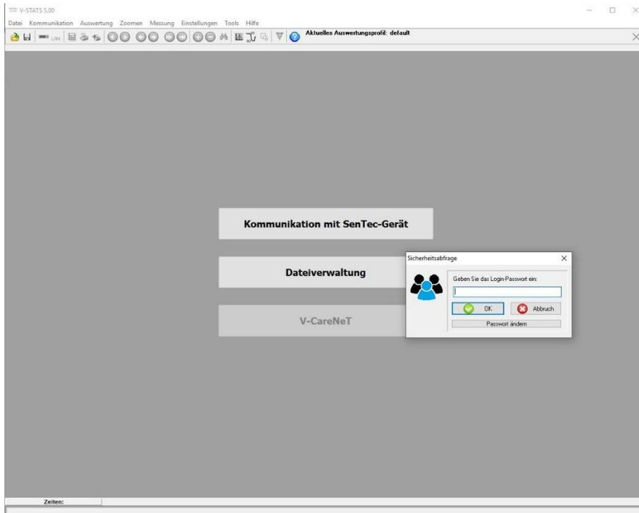
Das Passwort zum Schutz der V-STATS-Einstellungen, SDM-Profile & Konfiguration und Sonderfunktionen wird als Admin-Passwort bezeichnet, um es vom Login-Passwort zu unterscheiden.
